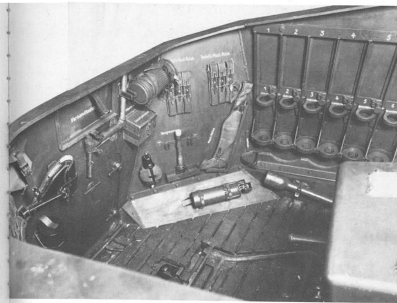
Die drei Bilder geben Einzelheiten des oben offenen Kampfraumes dieser Selbstfahrlafette. Die Unterbringung der Munition ist gut zu erkennen. Kartuschen und Granaten wurden getrennt gelagert.
