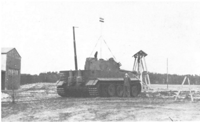
Das Versuchsfahrzeug V3 für UK-Fahrt hergerichtet. Die Kugelblende für das Funker-MG wurde durch eine besondere Kappe abgedeckt.
