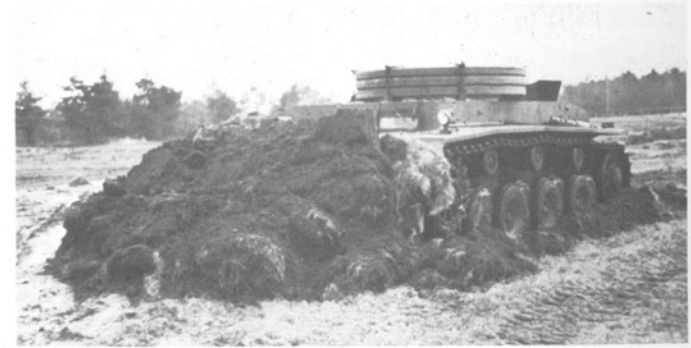
Das gleiche VK. 3001 (H) Fahrzeug beim Versuch mit dem Laufgrabenpflug LP 500 der Firma Scheid. Rückansicht des Fahrzeuges mit angebautem Pflug.
