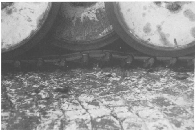
für den Winterbetrieb wurden Gleiskettengreifer geschaffen, die 20 bis 24 mm über den eigentlichen Kettensteg hinausragten.
