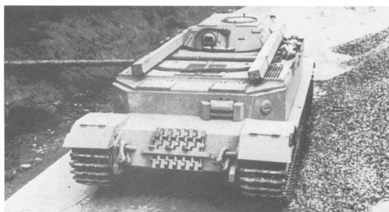
Bildfolge links: Die beiden Panzerjäger Abteilungen Tiger (P) erhielten Abschleppfahrzeuge gleicher Bauweise, die jedoch keinen verstärkten Panzerschutz aufwiesen. Es stand ein MG 34 zur Nahverteidigung zur Verfügung.
