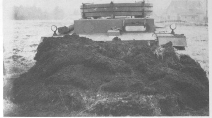
Die stark verdichtete Erdmasse staut sich gegen die kastenförmig ausgebildete Stauwand.
