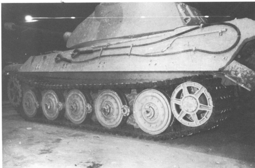
Das Bild zeigt eines der ersten Tiger B Fahrzeuge mit dem Porscheturm.
