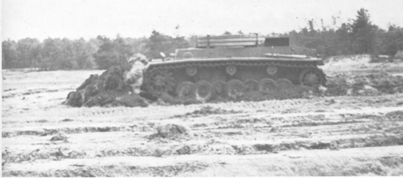
Der Panzerkampfwagen VK. 3001 (H) mit vor sich herschiebenden Erdmassen bei einer Geschwindigkeit von ca. 2,5 km/h.
