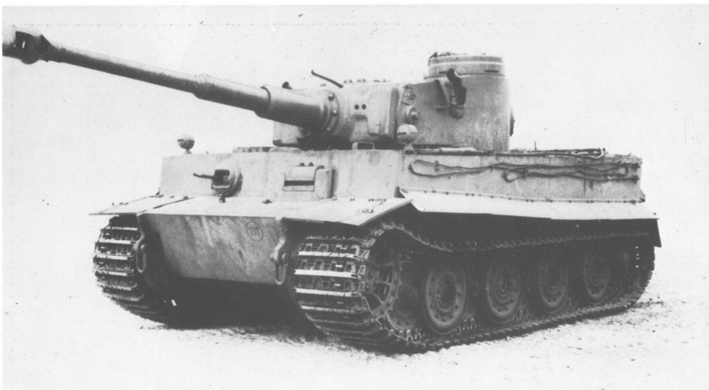
Nachdem etwa 800 Fahrzeuge gebaut worden waren, wurde das Laufwerk auf die gummissparenden Stahlaufrollen umgestellt. (Fahrgestell-Nummer 250822).
