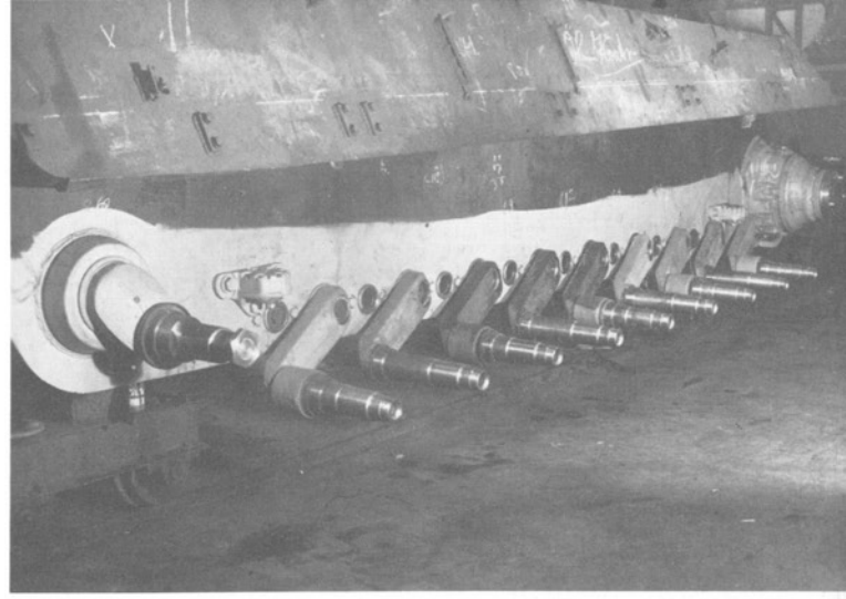
Hier sind alle Tragarme einer Fahrgestellseite eingebaut, ebenso die verstellbare Spindel der Kettenachstellung am Leitrad. Die Tragarme zeigten auf beiden Fahrzeugseiten in entgegengesetzte Richtung.
