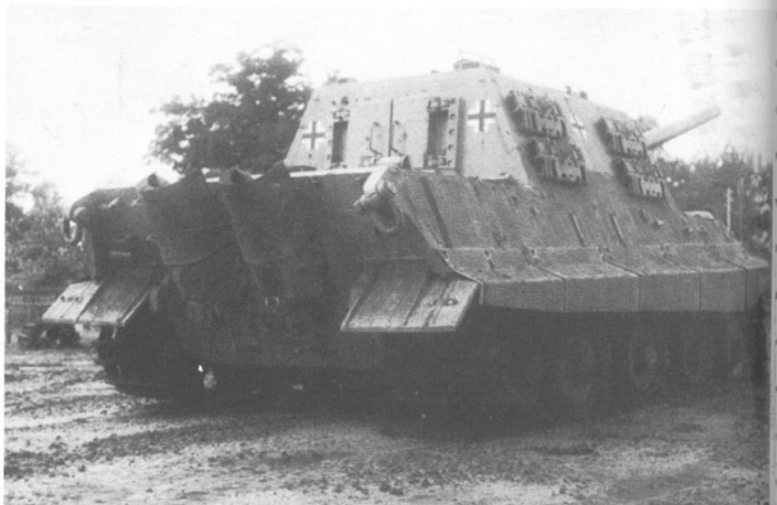
Der Jagdtiger halbrechts von hinten gesehen. Am Heck sind die Abschleppbügel eingehängt.
