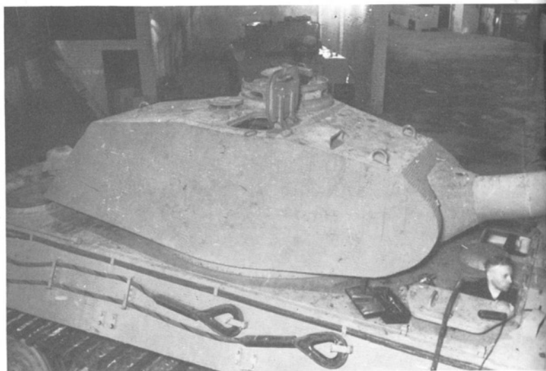
Der Drehturm zeigt die Einstiegluke im Turmdach sowie die offenen Luken für Fahrer und Funker.
