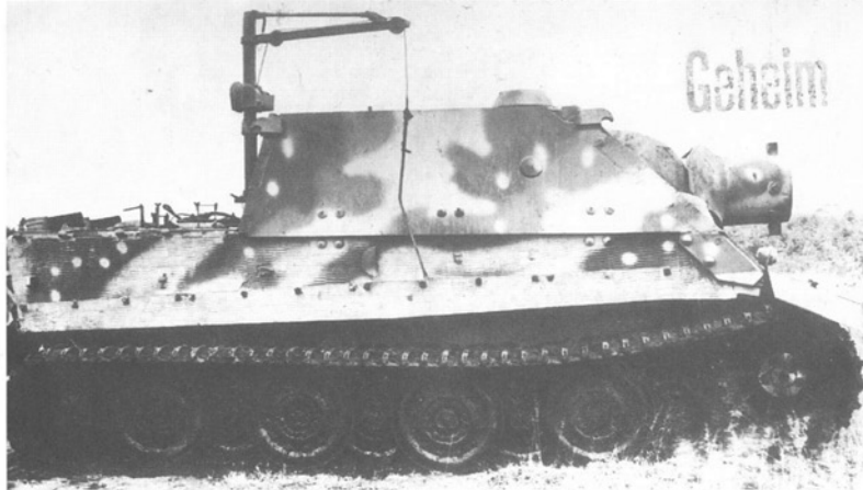
Panzermörser 38 cm, rechte Fahrzeugseite, mit Ladekran.
