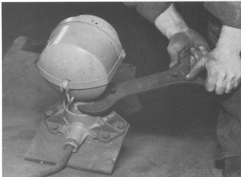
Vorne an der Bugplatte wurde der abnehmbare Scheinwerfer befestigt.
