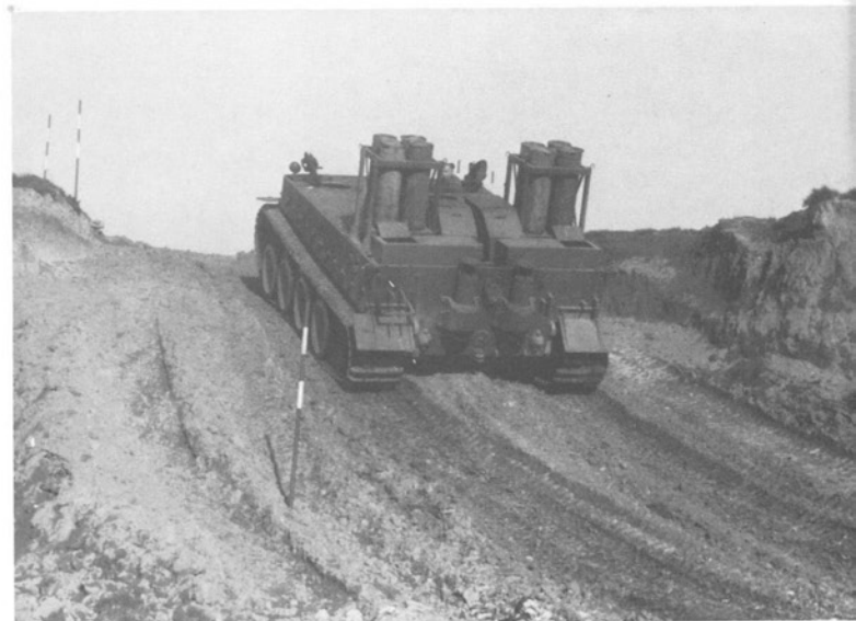
Mit Belastungsringen wurden während der Fertigung einzelne Fahrzeuge in den Versuchsbetrieb genommen.
