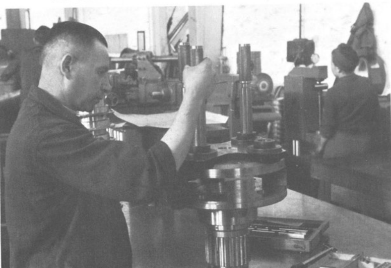
Die Kontrolle eines Planetenträgers.
