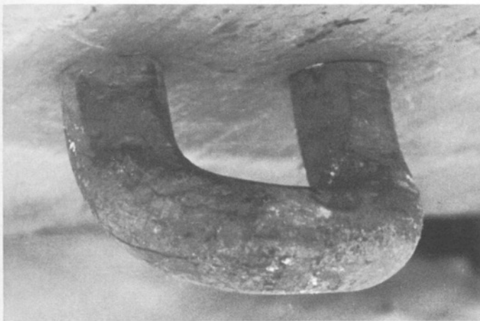
Eine Bugschleppöse wurde geschaffen, um ein Fahrzeug beim Abschleppen seitlich herumziehen zu können.
