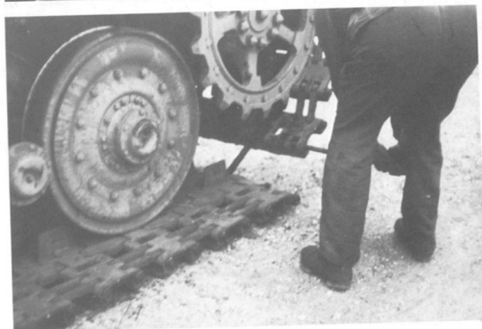
Diese Bilderserie zeigt das Aufziehen der Gleiskette bis zum Schließen.
