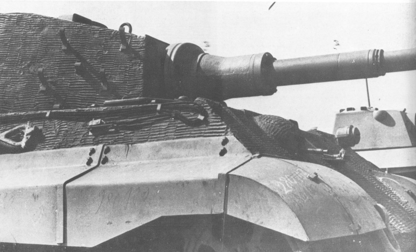
Die erste Vorstellung des Tigers B mit Produktionsturm (Fahrgestell Nr. 280100). Im Hintergrund sichtbar die 1 : 1 Attrappe des Panthers II.
