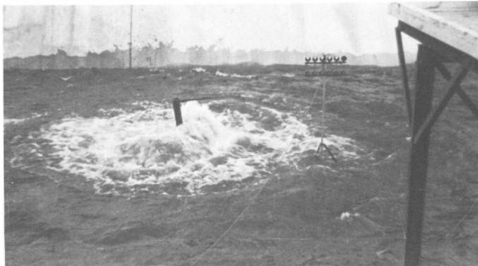
Die Auspuffgase verursachten die Wellenbildung an der Wasseroberfläche.
