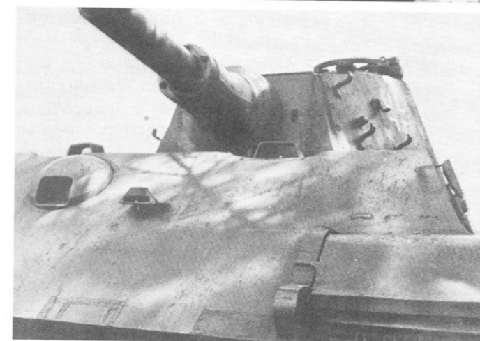
Eine Gegenüberstellung der Fahrzeuge Tiger B und Jagdtiger zeigt oben den Kampfwagen mit drehbarem Turm und der 8,8 cm KwK 43 L/71 und darunter den Jagdpanzer mit der 12,8 cm Pak 44 L/55.
