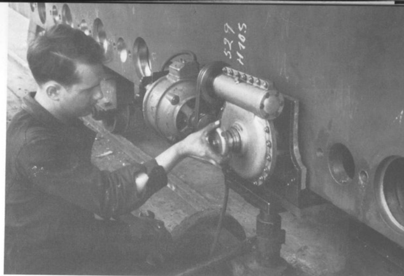
Das Einstechen der Nuten mit einem Spezialapparat bei der Wannensbearbeitung.
