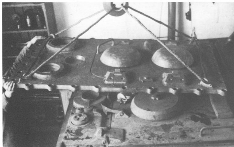
Die Abdeckung des Motorraumes wurde bei den letzten Baureihen dreiteilig ausgelegt und die Öffnung dabei vergrößert.
