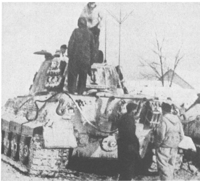
Ein Panzerbefehlswagen Tiger B. Äußerlich waren diese Fahrzeuge nur durch die zusätzlichen Antennen zu erkennen.
