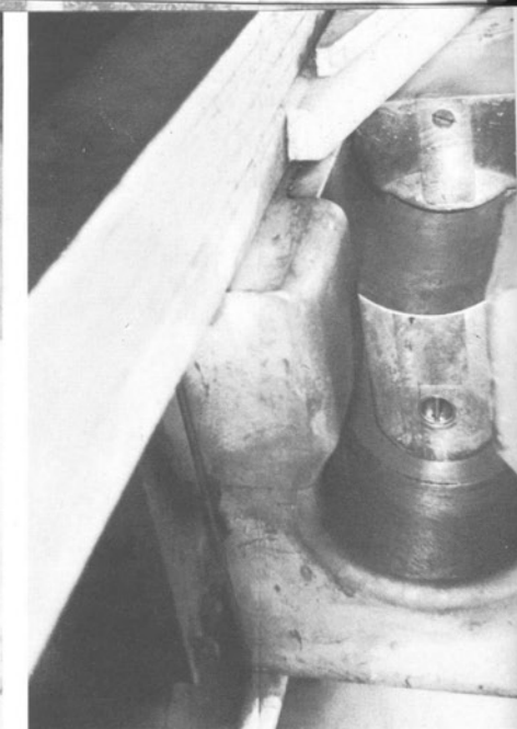
Der Verschuß der Kanone in geöffnetem und geschlossenem Zustand. Links sind die Gegengewichte angebracht.
