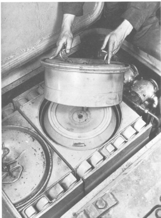
Die Luftfiltereinsätze werden auf dem Motor aufgesetzt.
