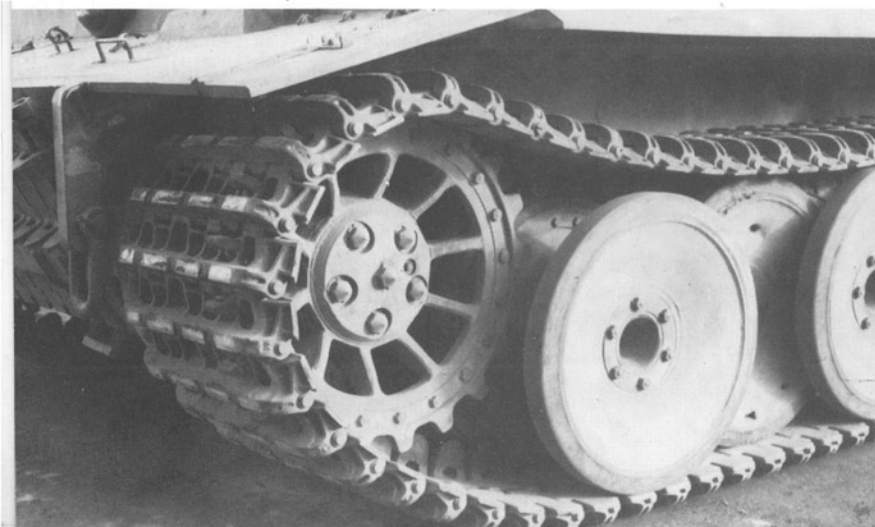
Das eingebaute Antriebsrad und andere Einzelheiten des Laufwerkes.
