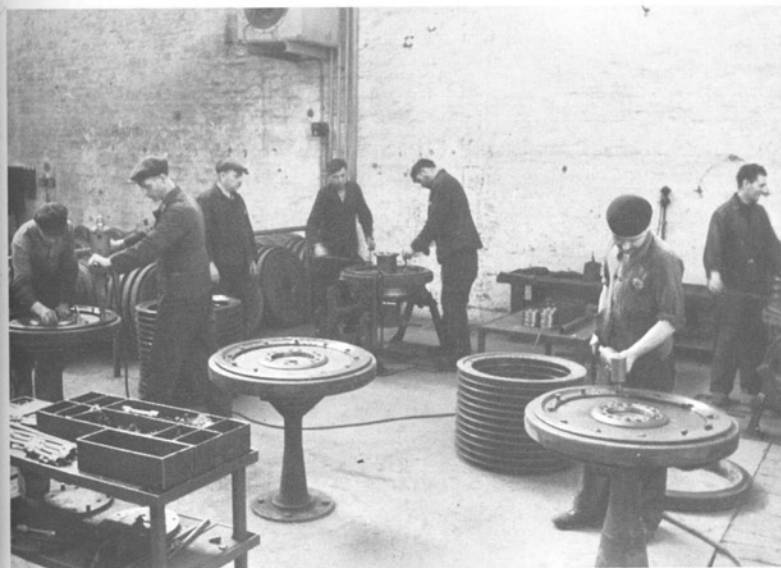
Der Zusammenbau der Laufräder in der Vormontage.
