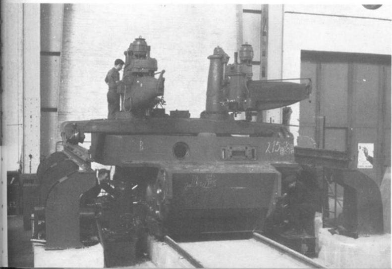
Das Bohren der Wanne unter dem Dachbohrwerk.
