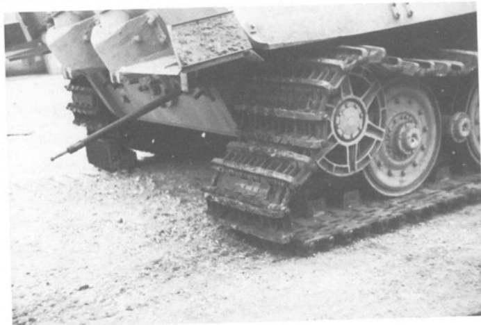
Diese Bilderserie zeigt das Aufziehen der Gleiskette bis zum Schließen.
