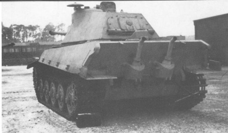
Das Fahrzeug von hinten mit Verladekette und abgenommenen Kettenschürzen.
