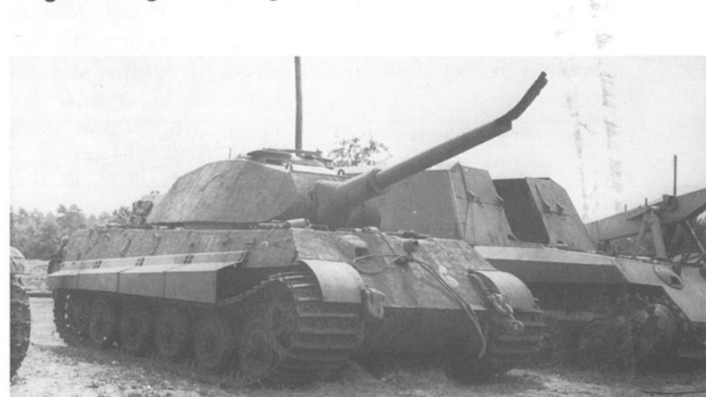
Vier Ansichten des Geschützwagens VI, der ein verlängertes Tiger B Fahrgestell verwendete.
