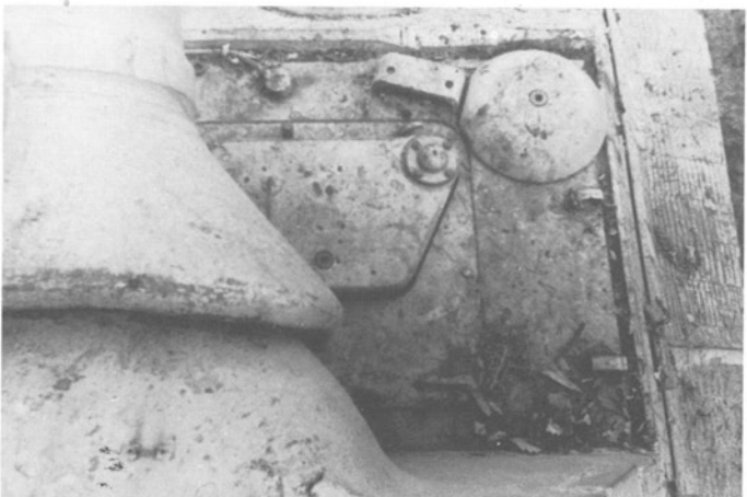
Das Bild zeigt die Funkerklappe in geschlossenem Zustand.
