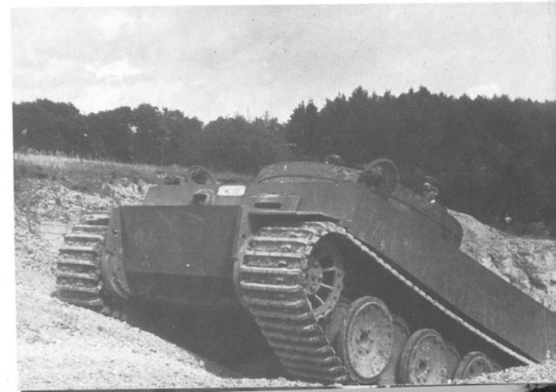
Mit Belastungsringen wurden während der Fertigung einzelne Fahrzeuge in den Versuchsbetrieb genommen.
