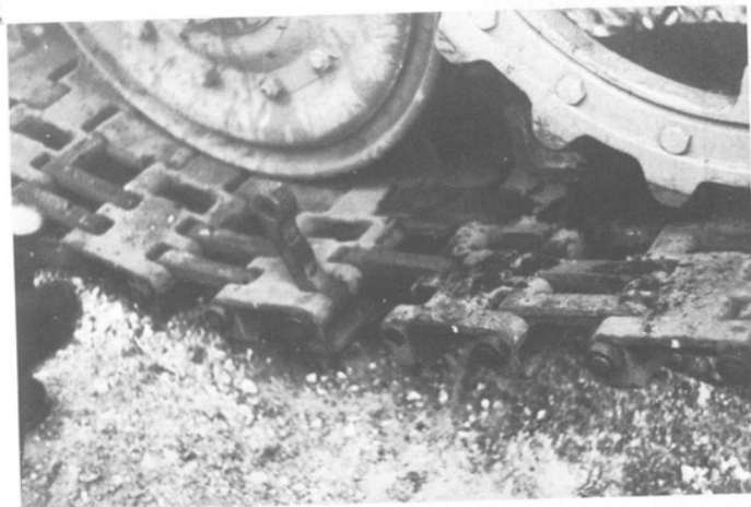
Diese Bilderserie zeigt das Aufziehen der Gleiskette bis zum Schließen.
