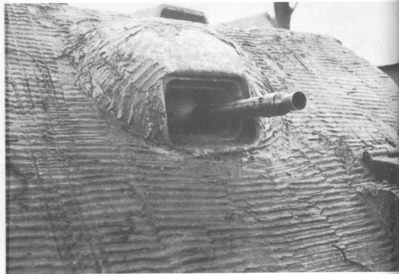
Die Optiköffnungen für das Turmzielfernrohr. Neben der Kanone war das Turm-MG gelagert.
