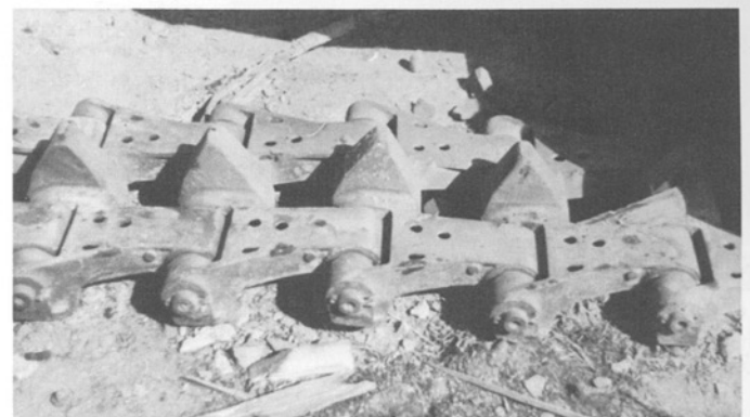
Die Gleisketten des Fahrzeuges »DW 2« hatten geschmierte Kettenglieder mit Nadellagerführung der Kettenbolzen.
