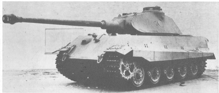
Gegenüberstellung der Tiger B mit Porsche-Turm (oben) und Produktionsturm.
