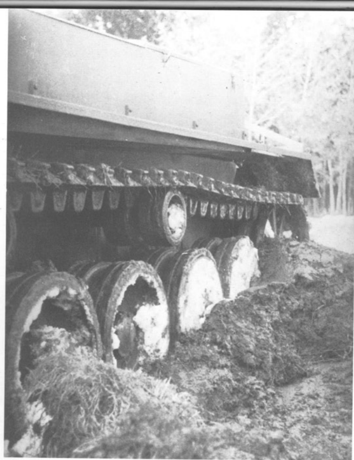
Das von der Firma Porsche entwickelte Versuchsfahrzeug VK. 3001 bei der Fahrerprobung im Gelände. Das Fahrzeug hatte einen benzinelektrischen Antrieb. Die Antriebsräder lagen vorne.
