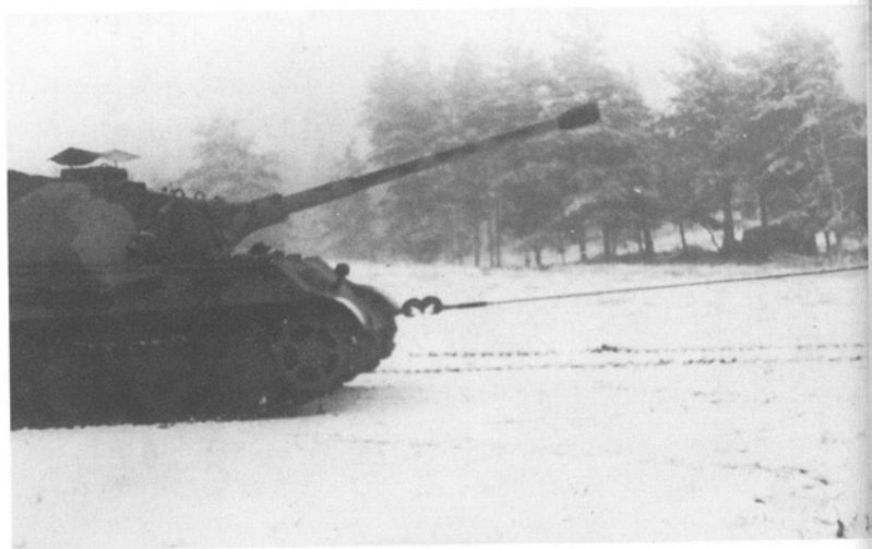
Die Bilder zeigen Versuche, bei denen ein Jagdtiger einen gebremsten Tiger B abschleppt.
