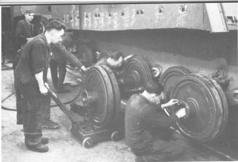
Das Aufsetzen der Laufräder auf die Schwingarme.
