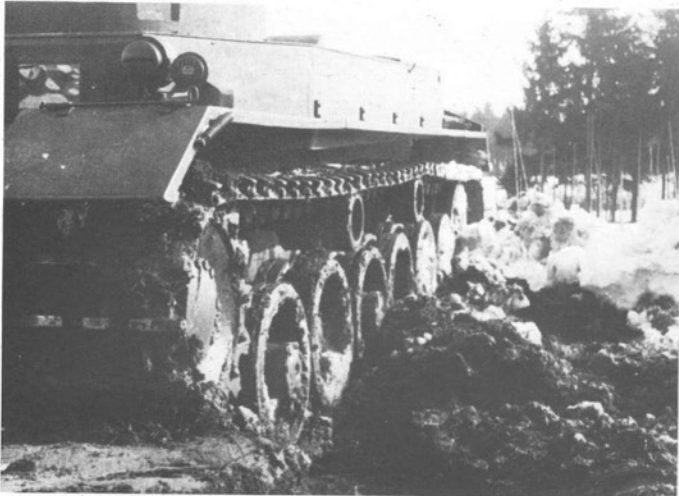
Das von der Firma Porsche entwickelte Versuchsfahrzeug VK. 3001 bei der Fahrerprobung im Gelände. Das Fahrzeug hatte einen benzinelektrischen Antrieb. Die Antriebsräder lagen vorne.
