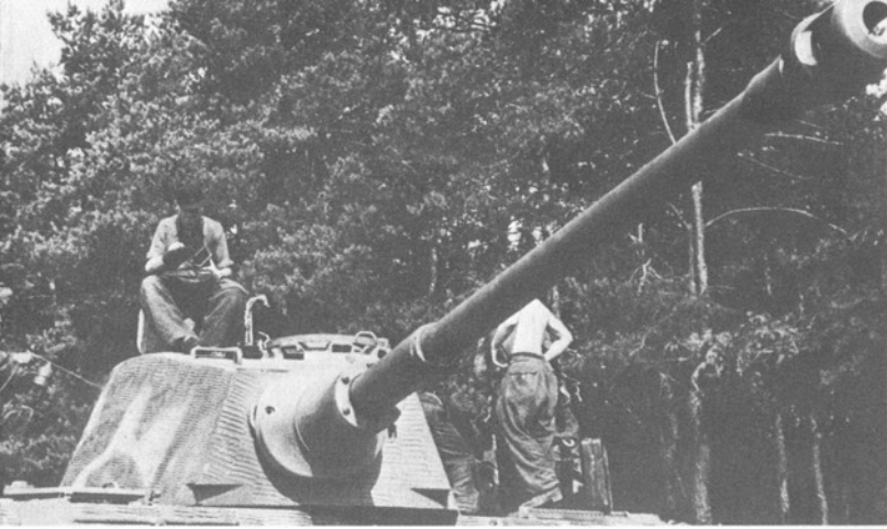
Die Einzelheiten des Turmes zeigen die verkleinerte, aber verstärkte Stirnplatte und die in einer »Saukopf«-Blende geführte lange Kanone.
