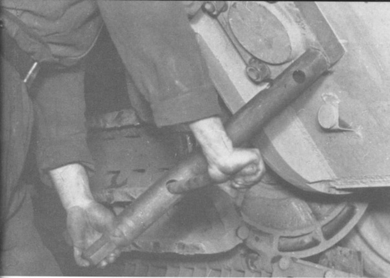
Die Deckel für die Kettennachstellung waren mit vier Muttern befestigt.
