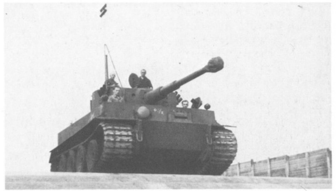
Oben zu erkennen das Teleskop mit Richtungsanzeiger. Davor die am Turm aufgebaute Lichtsignalanlage.
