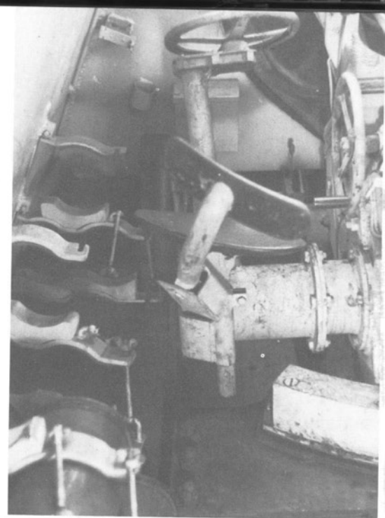
Der Richtschützensitz in Nahaufnahme. Links im Bild Halterungen für Kartuschen.
