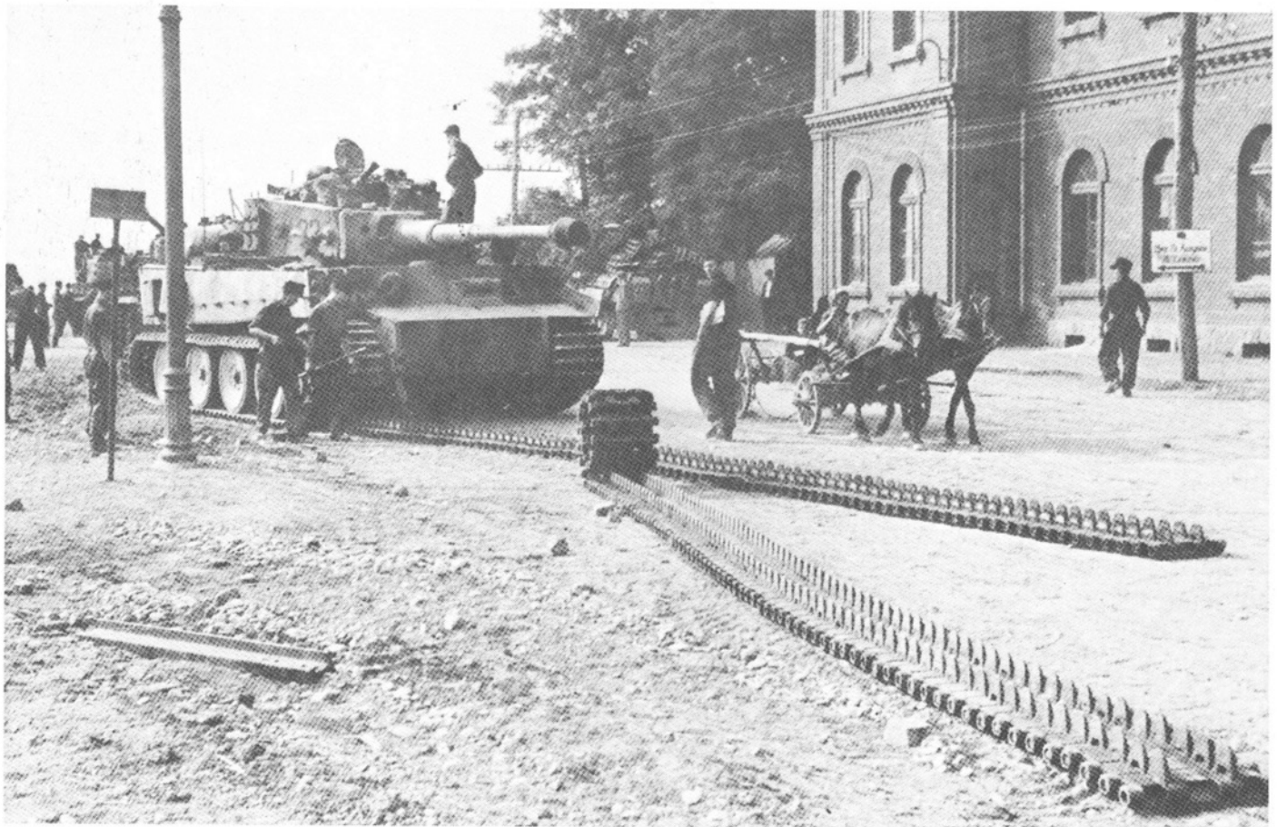
Das Kettenwechseln wurde schon in der Ausbildung eingehend geübt. Bei einem Kettengewicht von rd. 3 t keine Leichtigkeit (Zeitdauer 25 Minuten).
